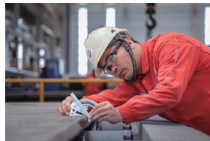
■ 施工人员测量加工后的板材坡口精度
