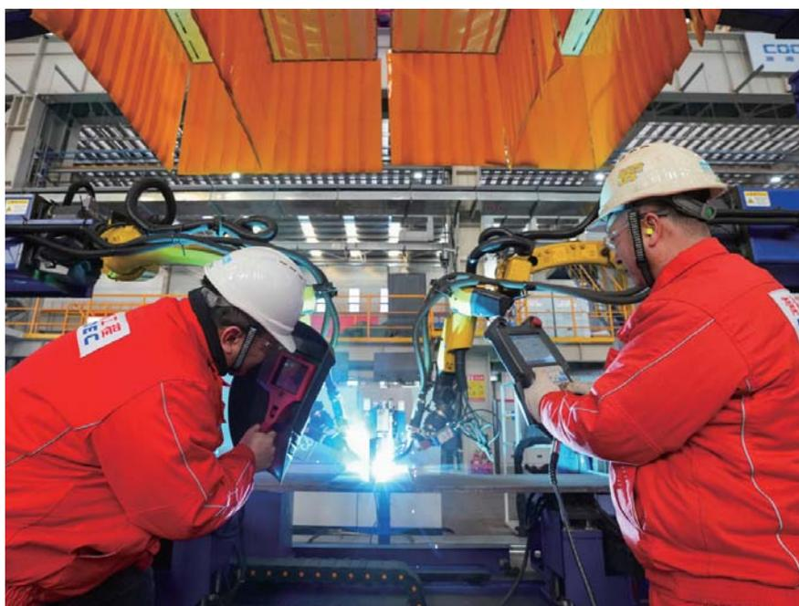
天津智能制造基地二期投产，施工人员正在调试智能焊接机器人
